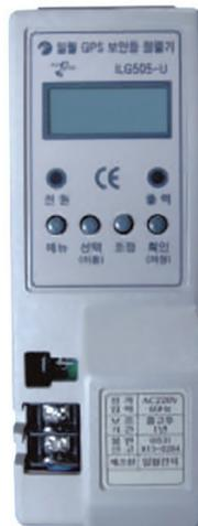
**개요** 전자식 보안등점멸기의 기능에 현재시간 보정을 GPS 수신을 이용하여 항상 표준시간을 유지하여 일괄된 제어가 가능하며 지역에 따른 점소등시간이 자동 보정되어 별도의 조정이 불필요한 제품이다.
